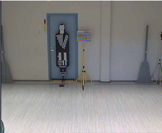
Kuva 6 Hylätty K 50. Kuvattu alue on liian leveä K50-kuvaksi tarkoitettussa ovipisteessä
