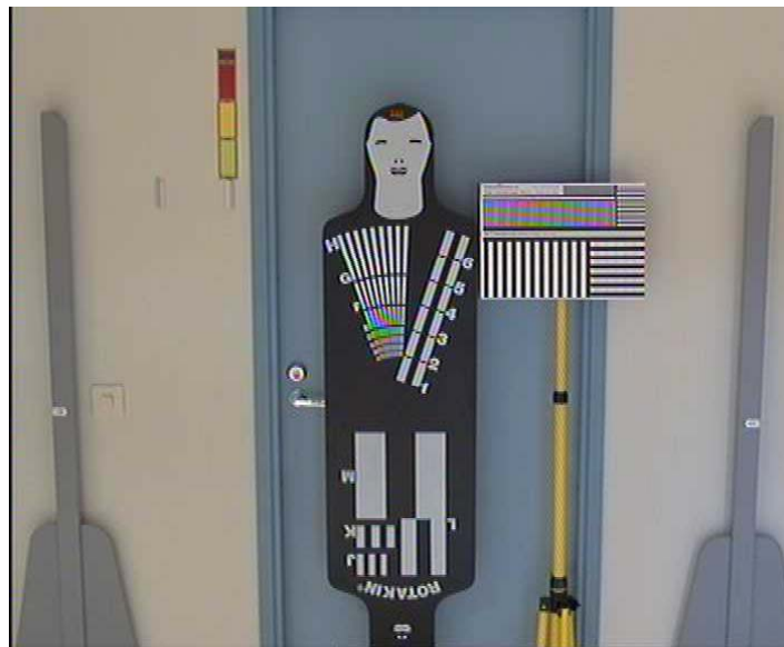
K120 valvottu paikka, K-testitaulu ja Rotakin-testikohde
